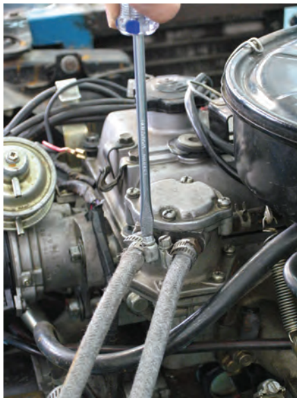
شکل ۱-۳۲ اتصال لوله سوخت به پمپ
