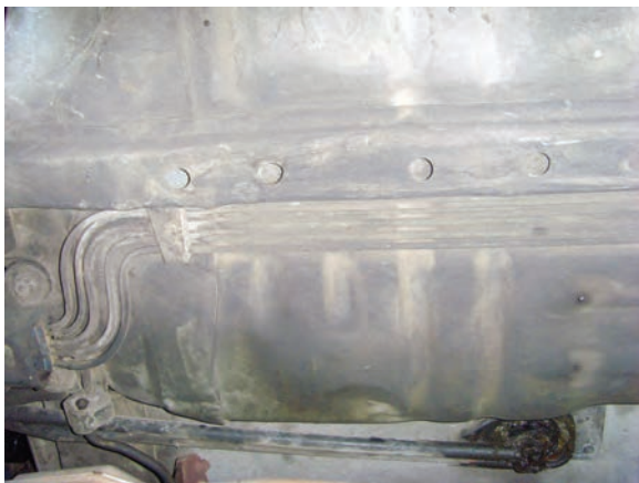
شکل ۱-۳۳ لوله سوخت از مخزن تا پمپ
