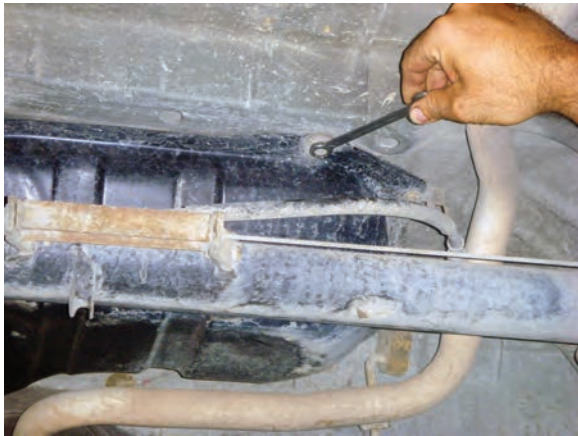
شکل ۱-۲۵ باز کردن پیچهای دور باک
