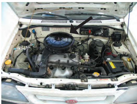
شکل ۵۰-۱ هواکش موتور کاربراتوری
