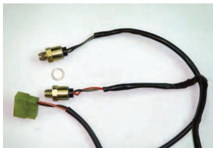
شکل ۱-۹۱ اجزای الکتریکی در یک نوع کاربراتور
