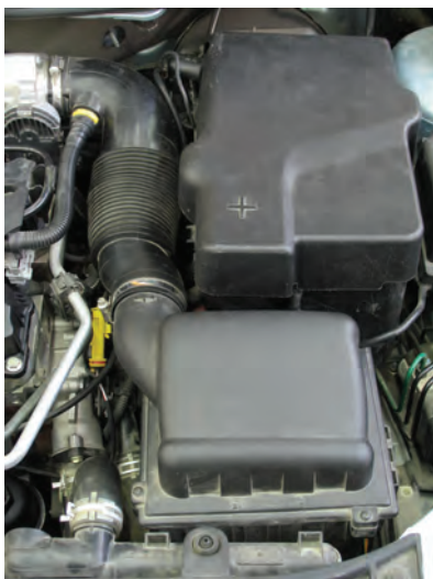
شکل ۵۱-۱ هواکش موتور انژکتوری
