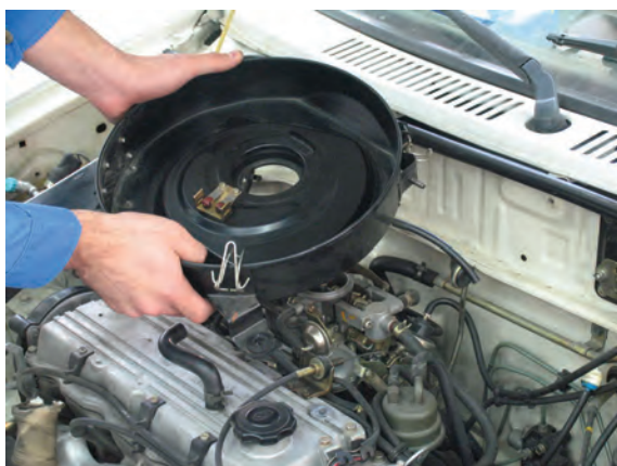
شکل ۱۱۴- ۱ پیاده کردن مجموعه هواکش
