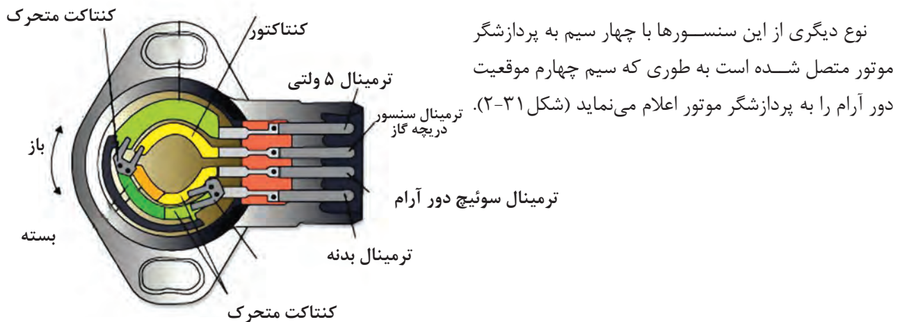
شکل ۲-۳۱- سنسور موقعیت دریچه گاز
