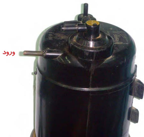
شکل ۱-۹۶ شیر ورودی سوخت‌های تبخیر شده به کنیستر
