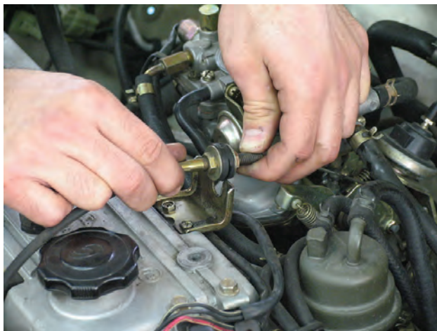
شکل ۱۱۵-۱ پیاده کردن کاربراتور
