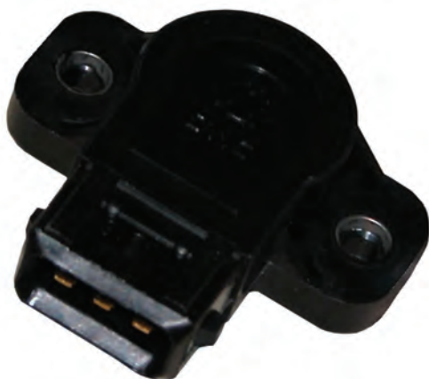
شکل ۲-۳۰- سنسور موقعیت دریچه گاز
